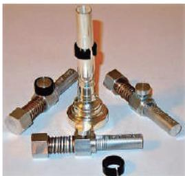
マウスピースとトランペットとの適正な組み合わせを知るためのアイテムです。マウスピースのシャンク末端から楽器本体のリードパイプ先端までの隙間「ギャップ」を測るための器具で、この数値によって次のような傾向が生じます。
